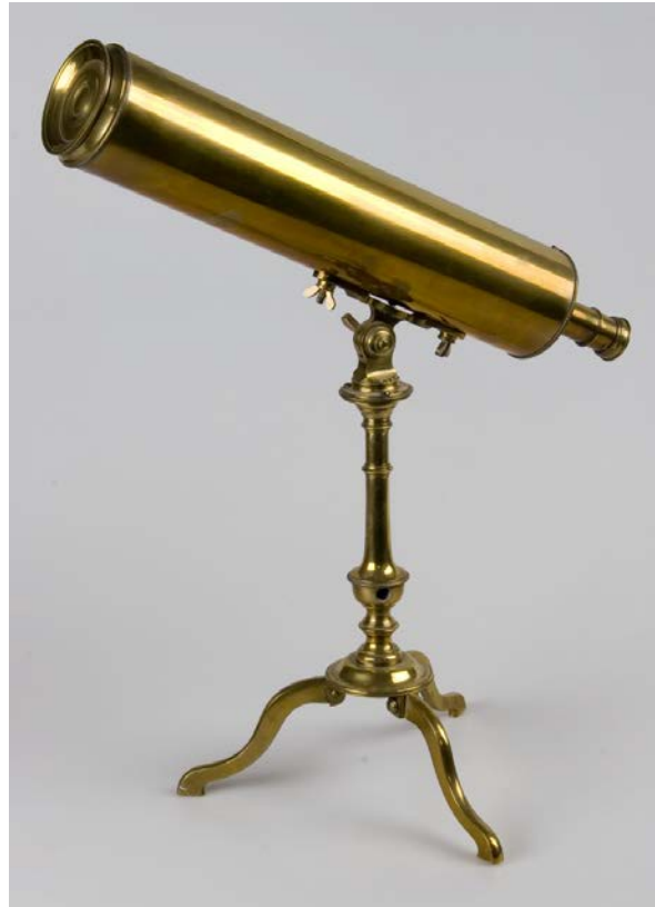
Spiegeltelescoop van het Gregoriaanse type, vervaardigd door Jan van der Bildt (Fries Scheepvaart Museum).
